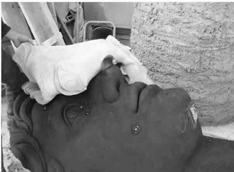
Il modello in cera del volto di Alessandro viene liberato dal negativo in silicone utilizzato nella fase della formatura.
