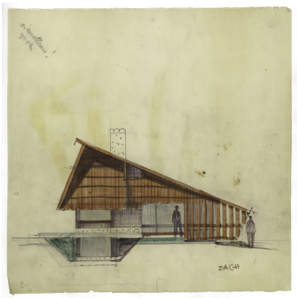
4 | Schizzo di studio su lucido del prospetto principale (ovest?) della seconda versione della casa di Szumin, s.d. Come nella prima versione, la posizione del camino spostato su un lato differisce dal progetto realizzato in cui il blocco stufa-cucina è collocato in posizione semicentrale. Gift of the Hansen family from the Archives of Zofia and Oskar Hansen. Collection of the Museum of Modern Art in Warsaw.
