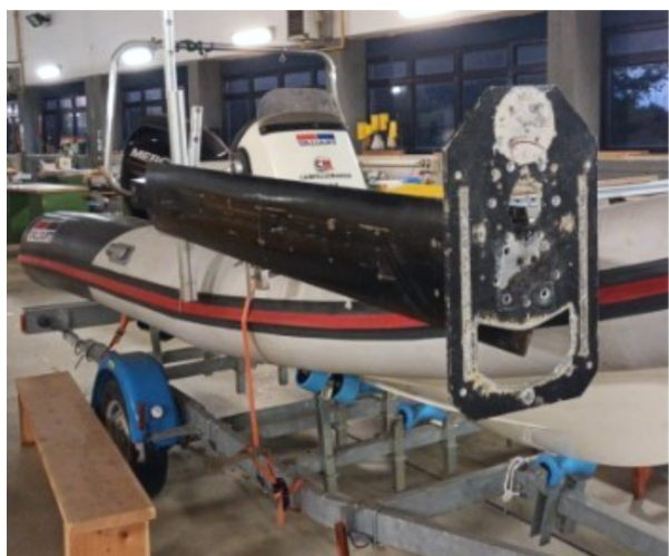
1 | Strumentazioni utilizzate e setup sull'imbarcazione con sistema MBES EM2040P e sistema inerziale e RTK.
